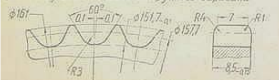
Профиль зубьев звездочки наружного барабана
