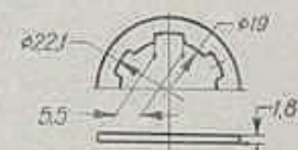
Упорная шайба (F) шестерни 2-й передачи
